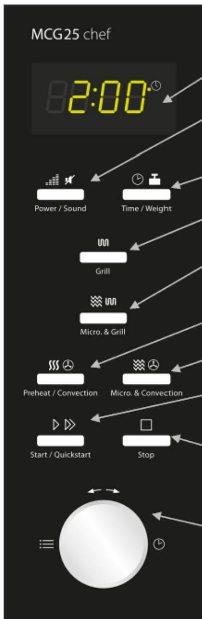
**Signalizační pole:** Ukazovány jsou doba vaření, výkon, ukazatel funkce a aktuální čas.
